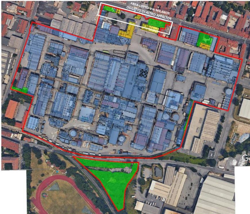
**Figura 5: Area dello stabilimento Caffaro. In blu gli edifici di cui al momento è prevista la demolizione, in giallo i fabbricati che saranno conservati, in verde le aree adibite a giardino**
